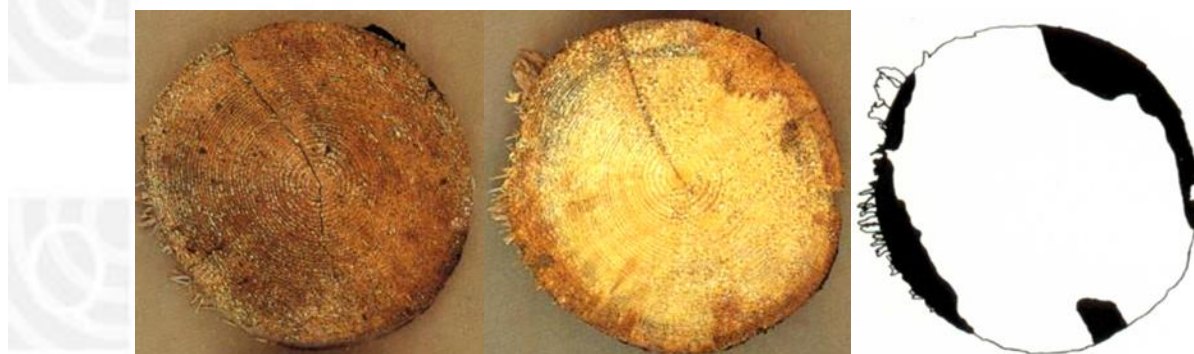
6. attēls. Egles glabāšanas trupe. Attēls pa kreisi: kokmateriāla gala plakne; vidējais attēls: svaigi zāģēta gala plakne no
