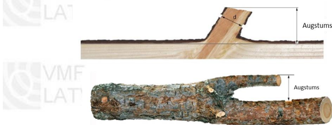
5. attēls. Zara un dubultgalotnes augstuma mērīšana
