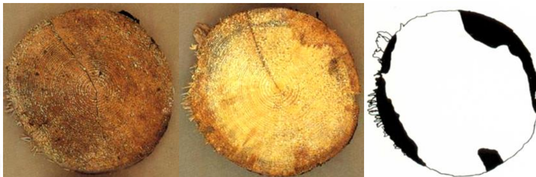
8. attēls. Egles glabāšanas trupe. Attēls pa kreisi: kokmateriāla gala plakne; vidējais attēls: svaigi zāģēta gala plakne no kokmateriāla, kas nozāģēts 15 cm no gala plaknes, attēls pa labi: glabāšanas trupe melnbaltā krāsā, glabāšanas trupe melnā krāsā, kokmateriāla caurmērs 20 cm, glabāšanas trupe 25% (Rötskador i massaved, Swedish Forest Agency, 1989).
