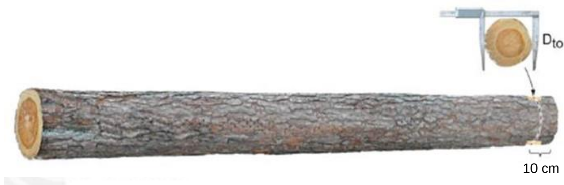
10. attēls Tievgaļa caurmēra uzmērīšanas vieta.
