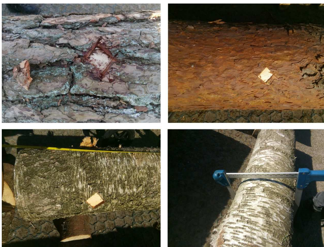
1.5. att. Rombveida mizas paraugu sagatavošana mizas biezuma novērtēšanai.
