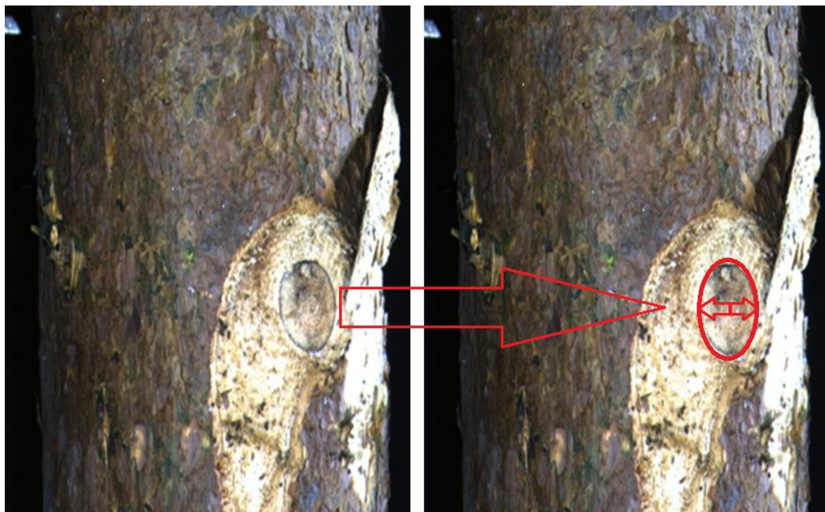
4. att. Zaru pielīdzināšana elipsei caurmēra novērtēšanā.
