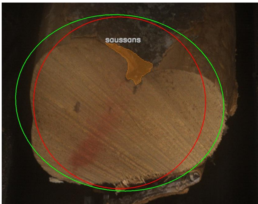
2.18. att. Sassāns bērza finierkluča lobīšanas cilindrā (sarkanā līnija).
