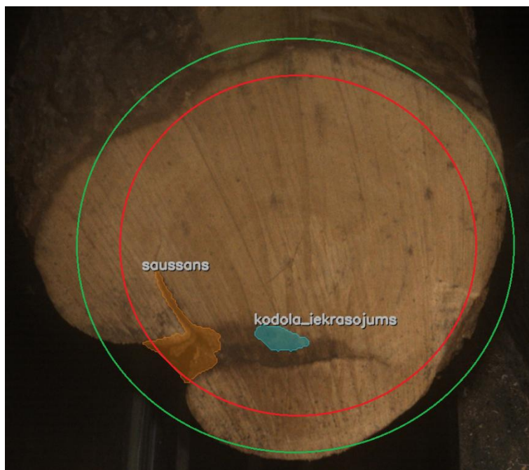
2.11. att. Saussāna novērtēšana bērza finierkluču gala plaknē (sarkanā līnija – lobīšanas cilindrs).
