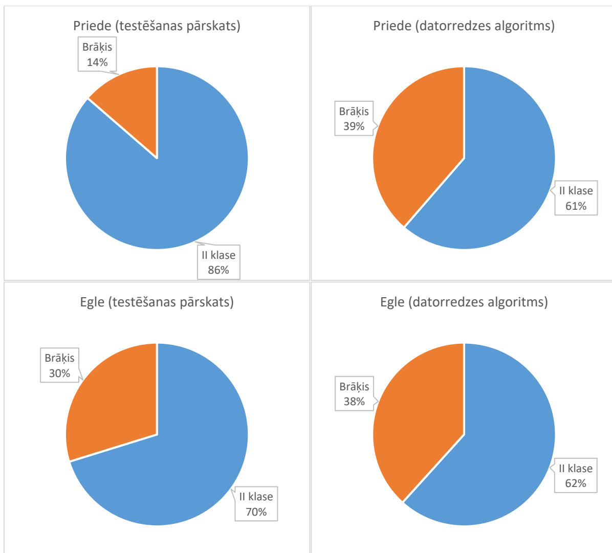
1.28. att. Skuju koku zāģbaļķa sadalījums pa kvalitātes klasēm pēc testēšanas pārskata un datorredzes algoritma izmantošanas.
