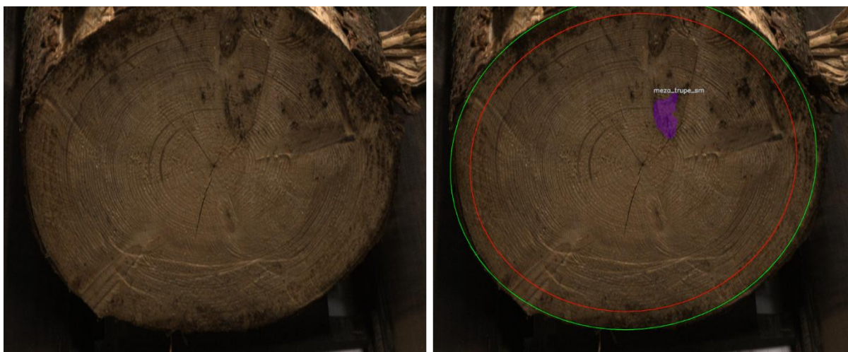
1.30. att. Minerālu piejaukums reģistrēts kā meža trupes bojājums.
