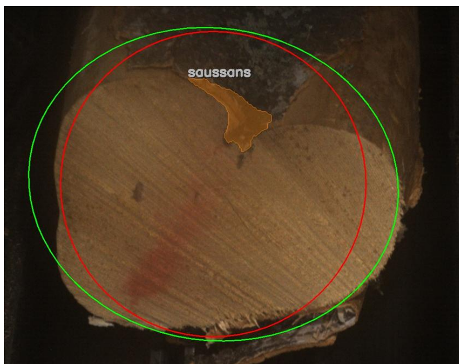
16. att. Saussāns bērza finierkluča lobīšanas cilindrā (sarkanā līnija).
