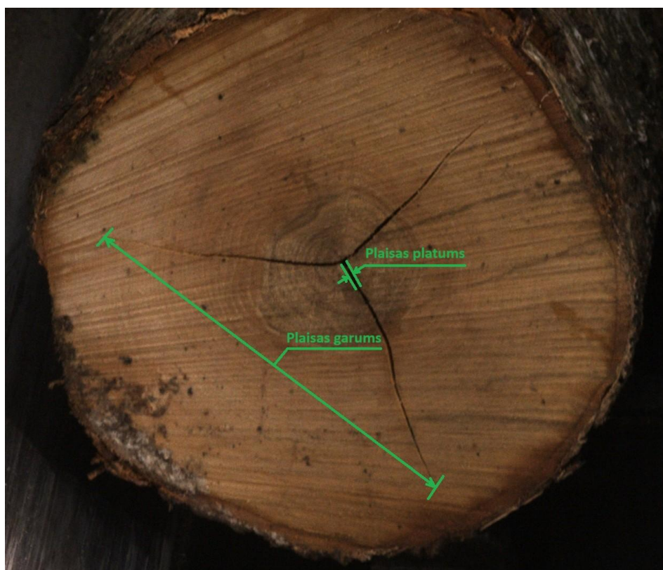
7. att. Serdes un žūšanas plaisas platuma un garuma uzmērīšana.
