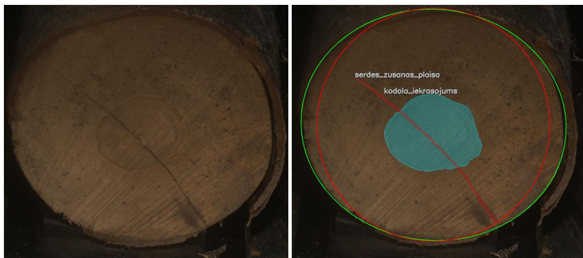
14. att. Bērza finierkluča gala plakne pirms un pēc datorredzes algoritma matemātisko modeļu izmantošanas.
