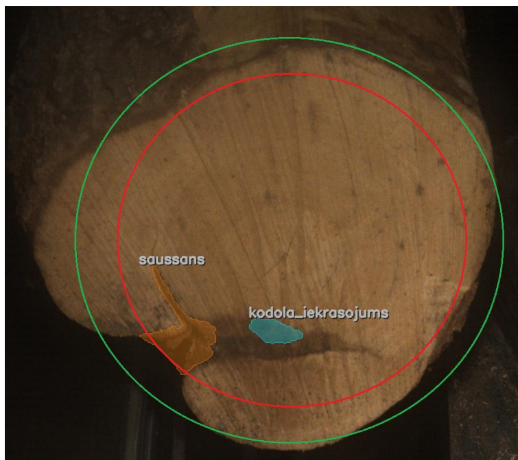
10. att. Saussāna novērtēšana bērza finierkluču gala plaknē (sarkanā līnija – lobīšanas cilindrs).
